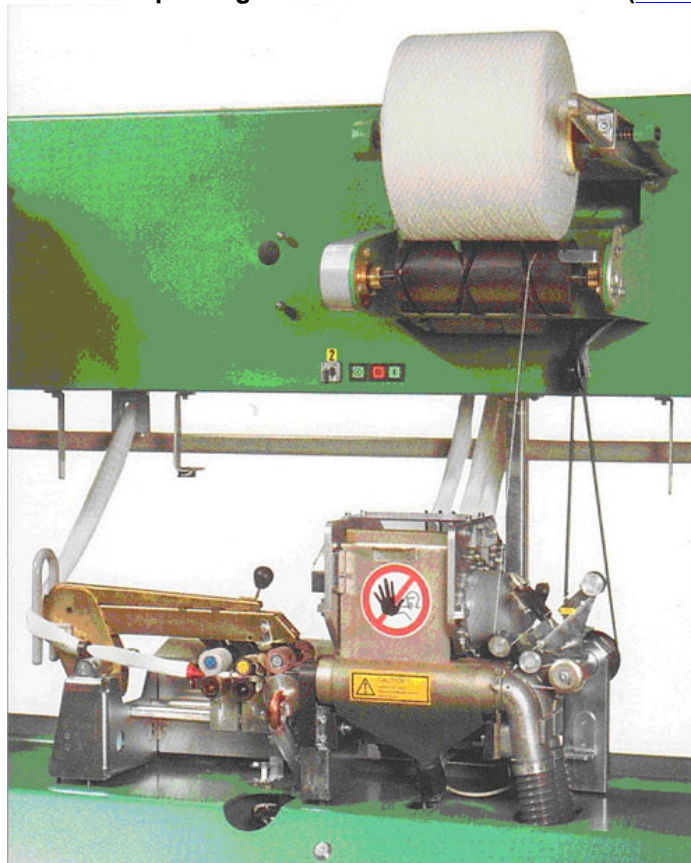
Figure 16.20 DREF 3000 spinning machine. Source: Fehrer AG ( www.fehrerag.com ).
